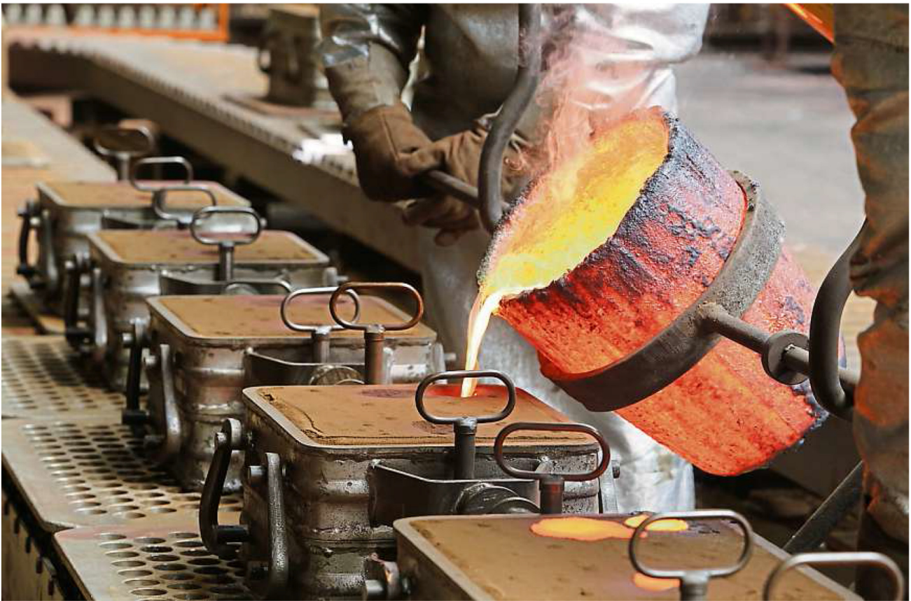
Ein Blick in die Halle der Metallgießerei „Kremer & Blöcher“ in Wallau: Heißes, flüssiges Aluminium wird in die vorbereiteten Form-kästen gefüllt. Foto: Kremer & Blöcher
