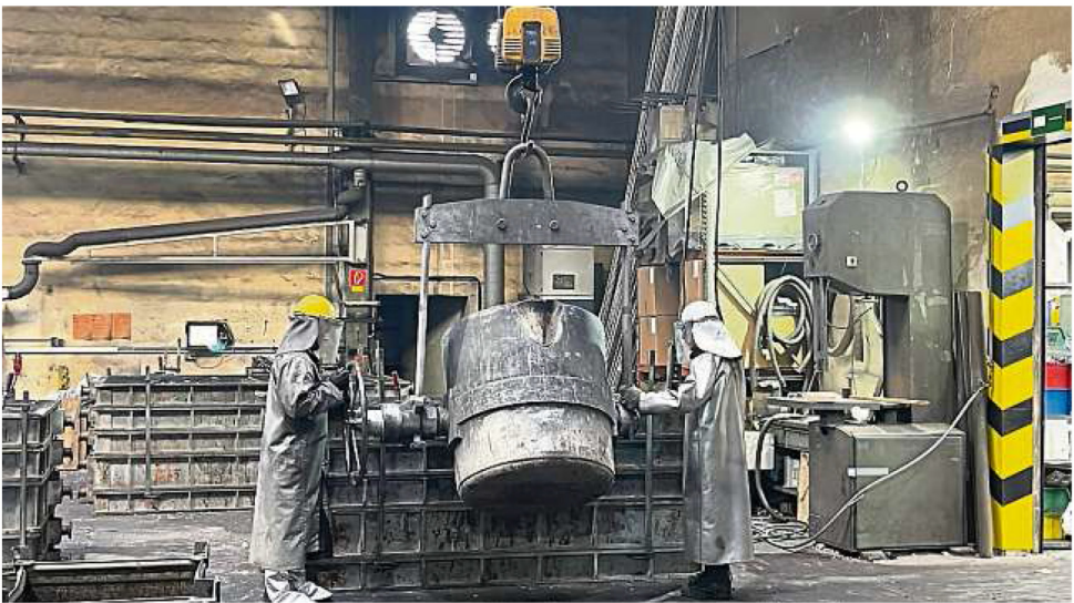
Zwei Gießereimechaniker in der Halle von „Kremer & Blöcher“ in Wallau. Ausgestattet mit Schutz-helm, feuerfestem Mantel, Handschuhen und Hitzeschutz-Gamaschen gießen sie das flüssige und heiße Metall in die vorbereitete Form. Foto: Carolin Acker
